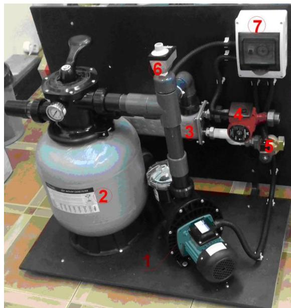
Стенд фильтрации бассейна с подогревом от котла, торговой марки ООО Баском, предназначен для фильтрации и циркуляции воды бассейнов и купелей с подогревом воды бассейна от котла через теплообменник.
