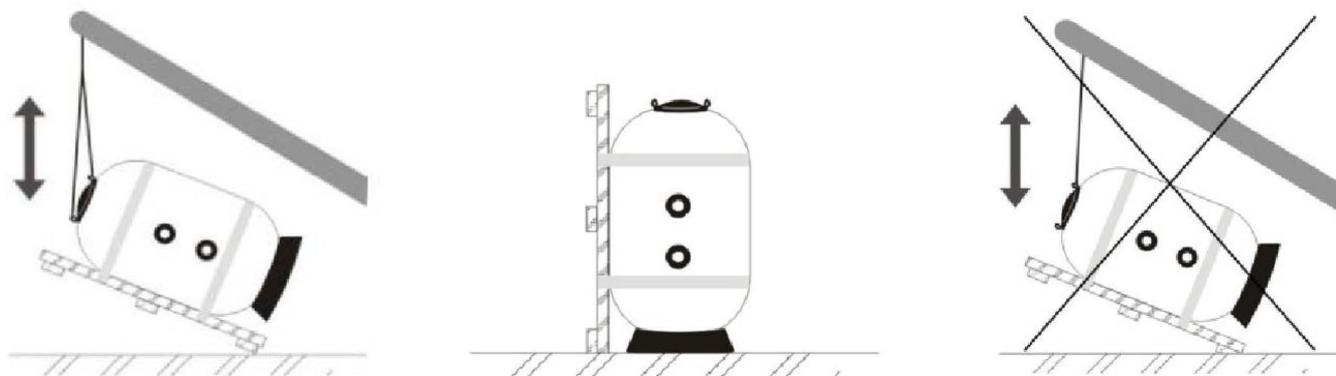
Использовать оба транспортировочных кольца для подъема фильтра из горизонтального в вертикальное положение
