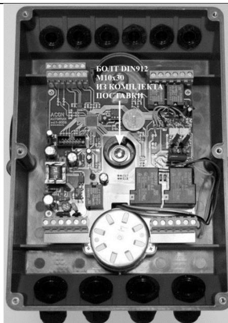
**!!! ВАЖНО !!! ДЛЯ ОБЕСПЕЧЕНИЯ БЕСПЕРЕБОЙНОЙ РАБОТЫ БЛОКА УПРАВЛЕНИЯ И ШЕСТИПОЗИЦИОННОГО КЛАПАНА!**
