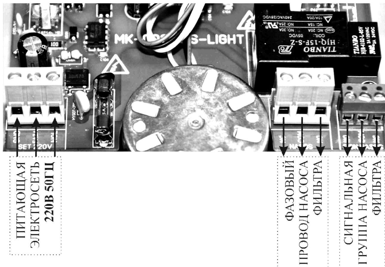
«SET 220V» - ПИТАЮЩАЯ ЭЛЕКТРОСЕТЬ 220В 50ГЦ – Электросеть 220В 50ГЦ с нулевым и заземляющим проводником, подключать строго в соответствии с указанными на плате надписям.
